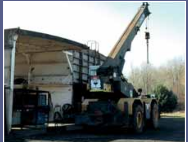
P&H Omega 18 Ton Rough Terrain Crane
